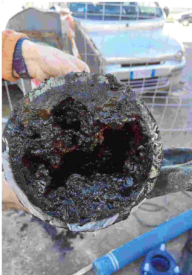
La riparazione di una perdita al Latte Dolce e a destra un tratto di condotta completamente marcio rimosso e sostituito in via Nobili
