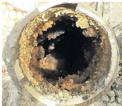
A destra i vasconi che servono a rendere potabile l'acqua. A sinistra le condizioni di una porzione di condotta sostituita tempo fa a Sassari
